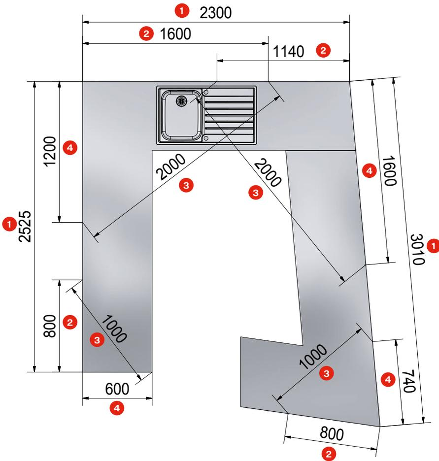
Chaque angle peut être défini au moyen de 3 dimensions conformément au système suivant:
