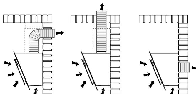
Evacuation de l'air par le mur au-dessus de la hotte, par un tube d'évacuation situé à l'intérieur de la gaine
